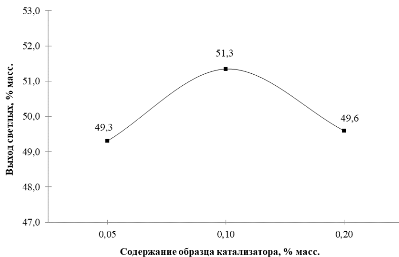
Рис. 4.2. Зависимость выхода светлых нефтепродуктов от содержания катализатора
