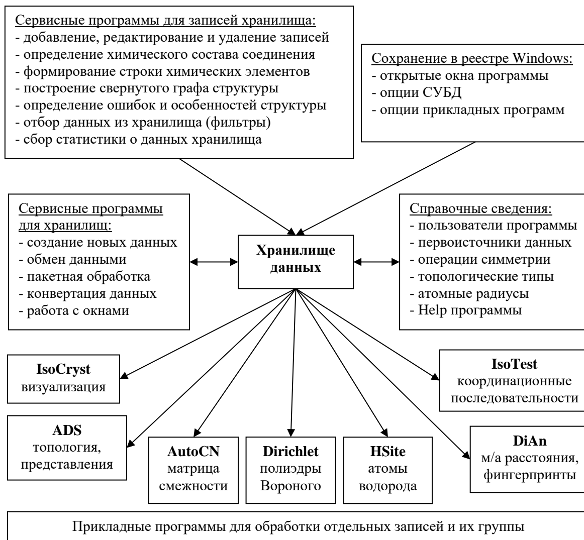
Схема 1. СУБД программного комплекса ToposPro и его модули.
